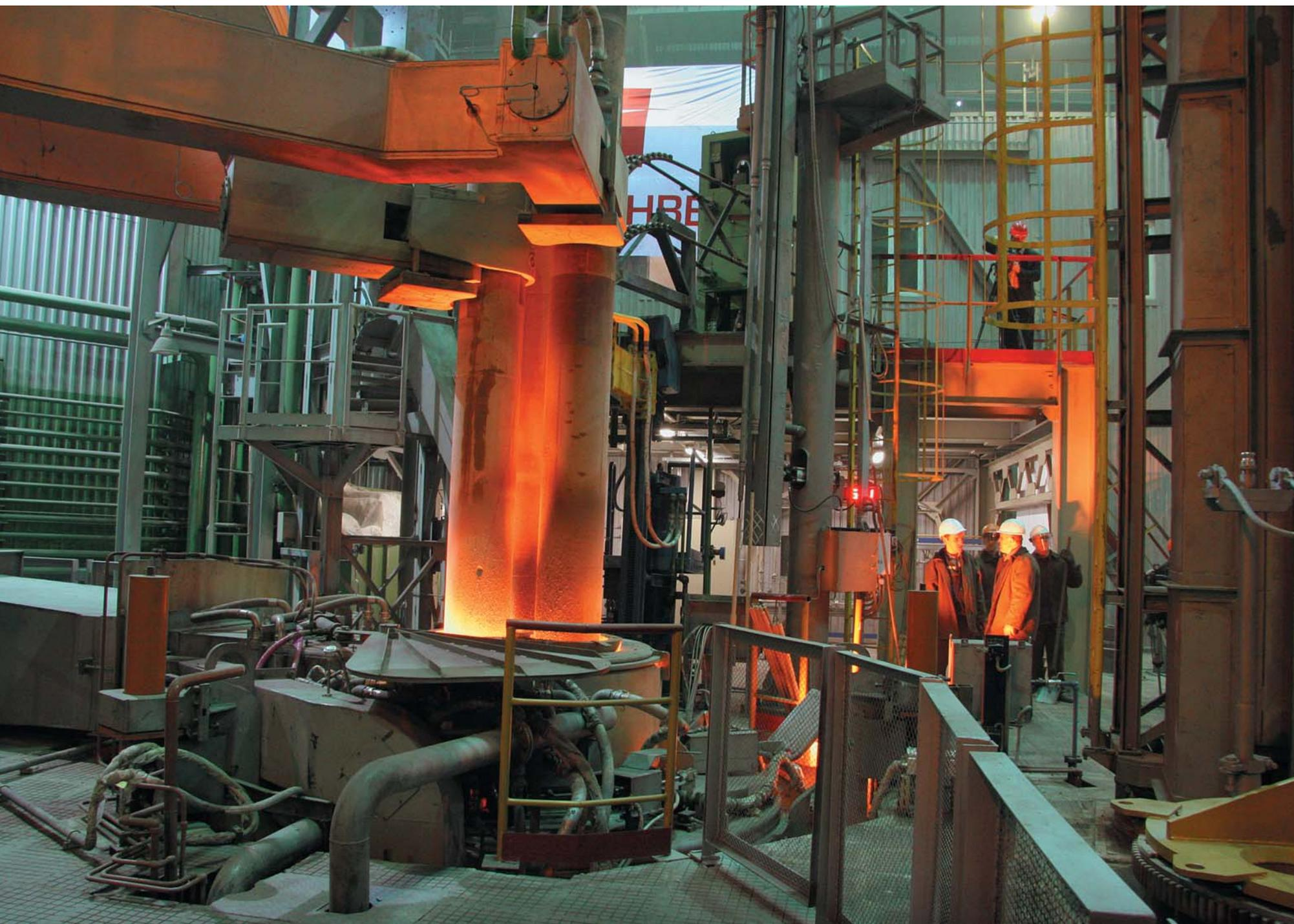
Агрегат комплексной обработки
