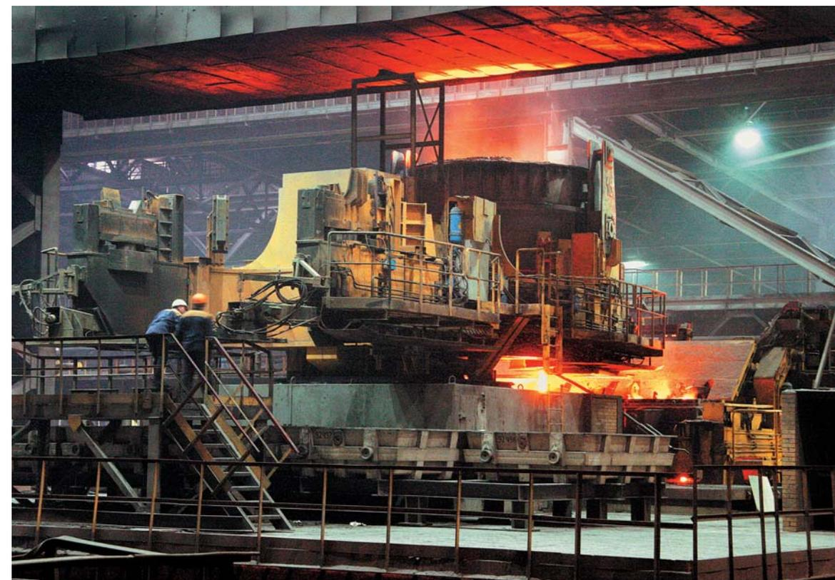
Машина газовой резки
