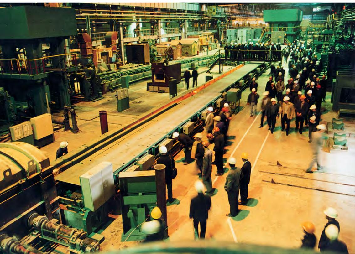
прокатного стана, ставшее отправной точкой в череде пусконаладочных работ в СПЦ № 2. В условиях, максимально приближенных к рабочему режиму, прошло испытание узлов и механизмов. 20 мая была получена первая опытная продукция мелкосортной линии—бунты проката диаметром 12 мм.
