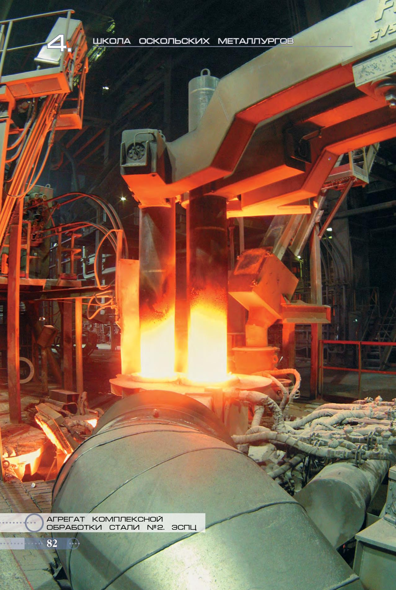
АГРЕГАТ КОМПЛЕКСНОЙ ОБРАБОТКИ СТАЛИ №2. ЭСПЦ
