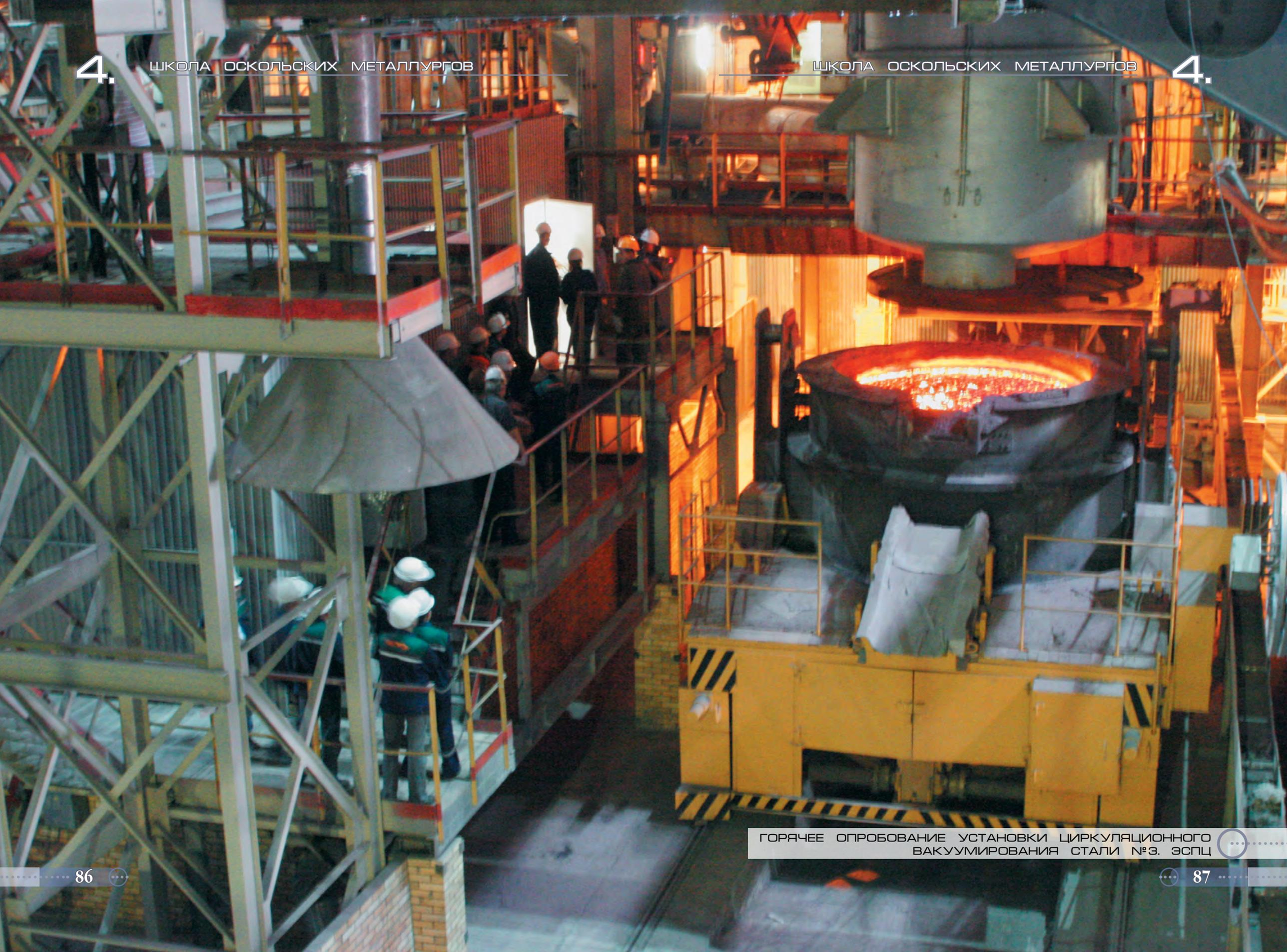
ГОРЯЧЕЕ ОПРОБОВАНИЕ УСТАНОВКИ ЦИРКУЛЯЦИОННОГО
