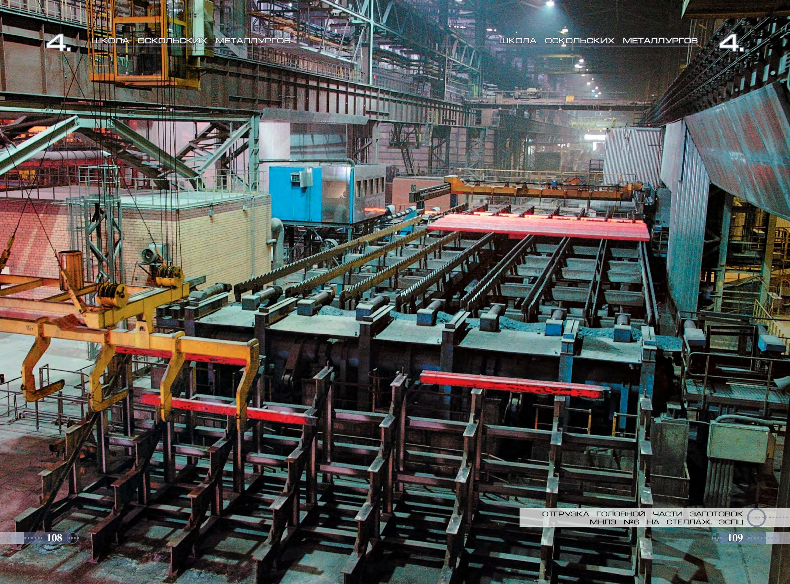
ОТГРУЗКА ГОЛОВНОЙ ЧАСТИ ЗАГОТОВОК
