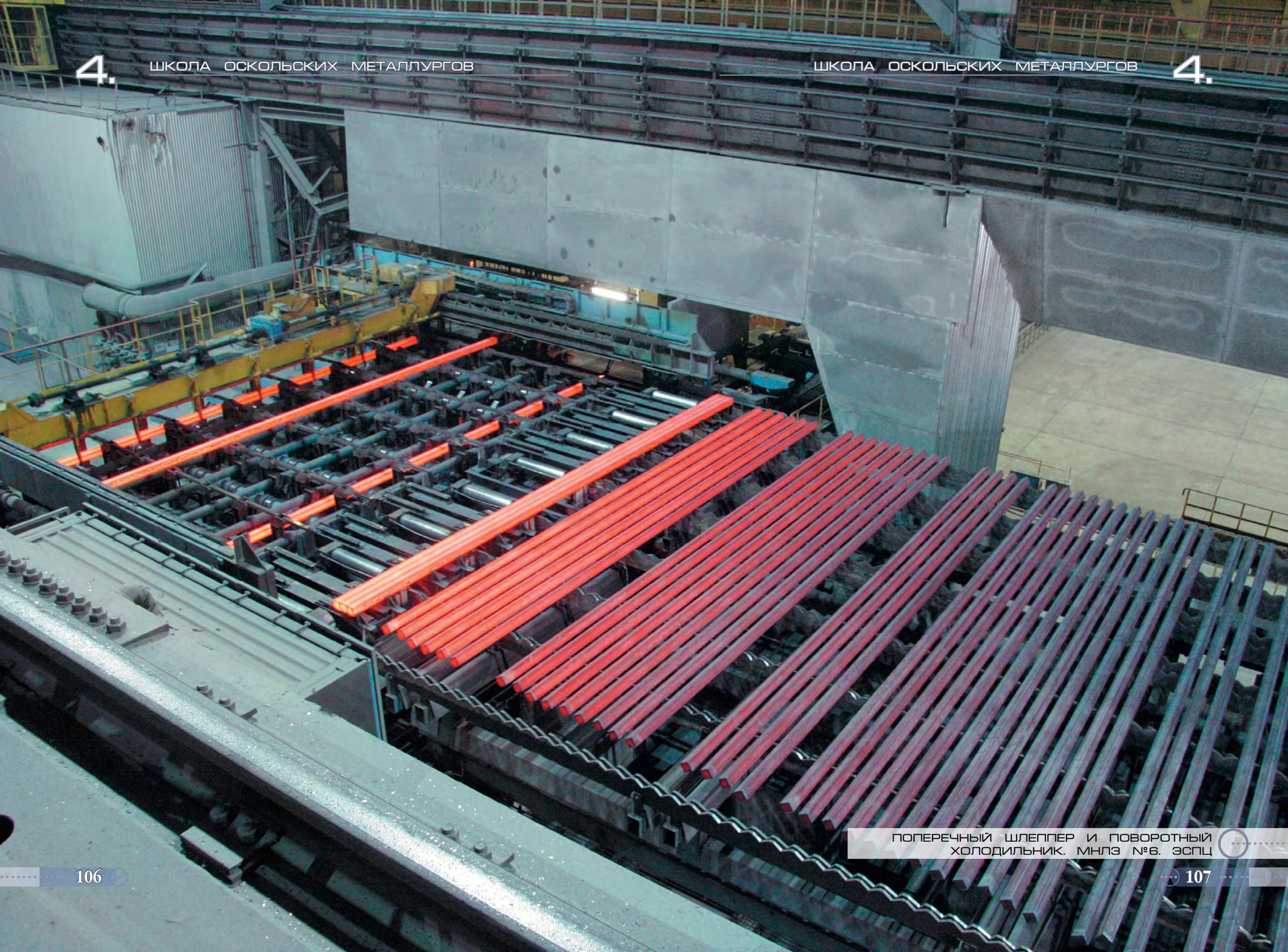
ПОПЕРЕЧНЫЙ ШЛЕППЕР И ПОВОРОТНЫЙ
