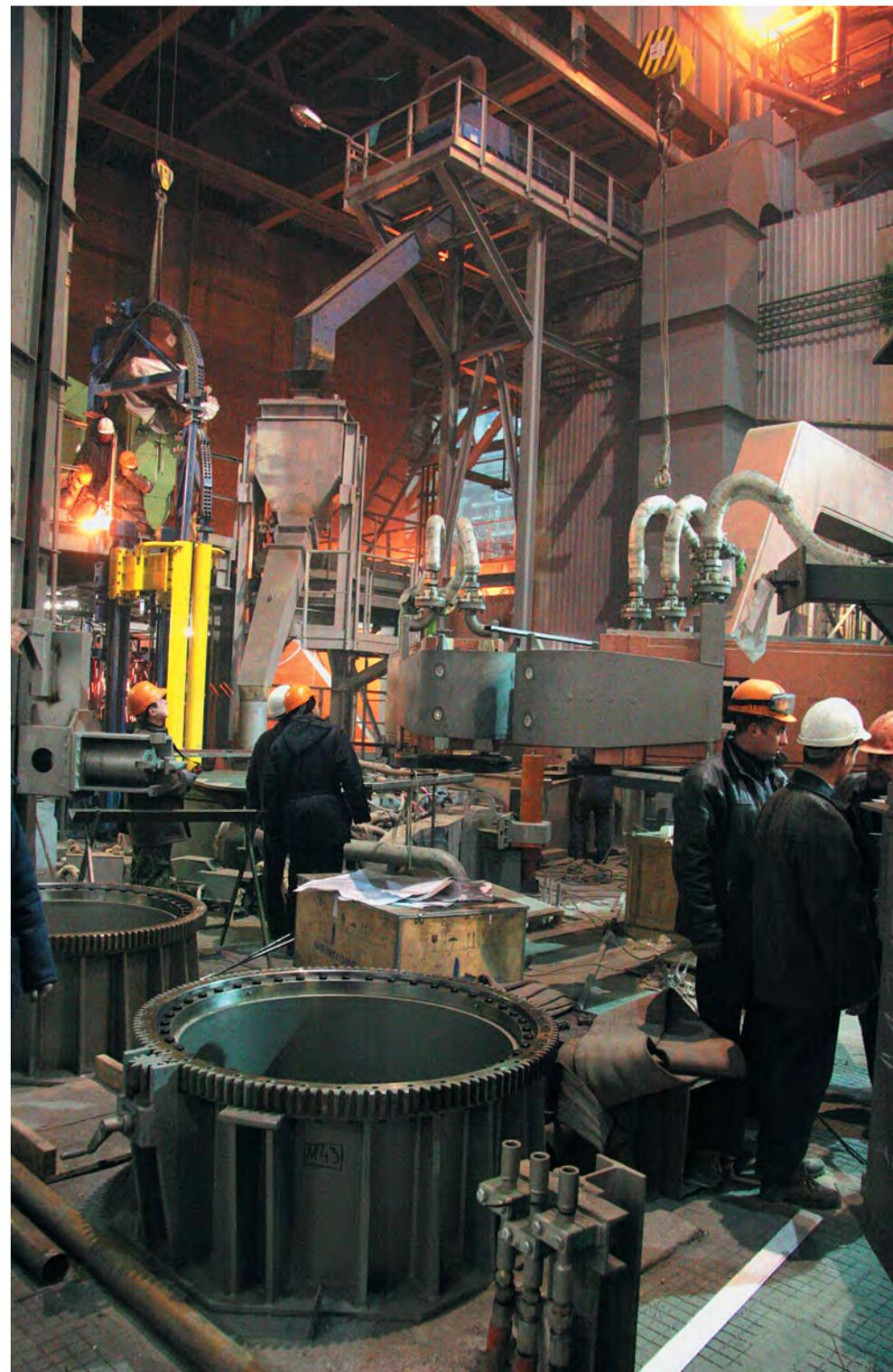
Ввод в эксплуатацию мостового разливочного крана №23 грузоподъёмностью 260/80/10 тонн фирмы Kralovopolska (Чехия), обеспечивающего передачу металла от дуговых сталеплавильных печей к МНЛЗ.
