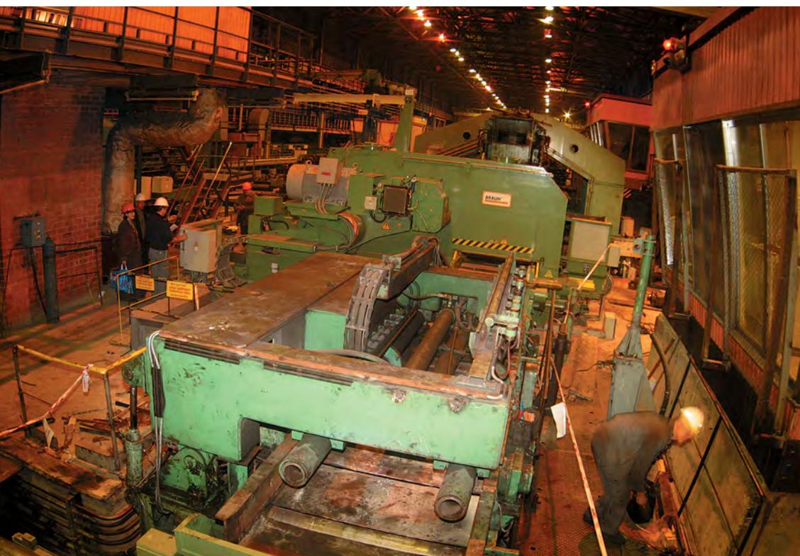
в состав оборудования стана включены установки преддеформационного и последдеформационного ускорения охлаждения проката, а также три печи поточной термообработки проката.
